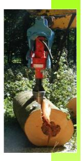
Il cuneo spaccalegna è un attrezzo collegabile ai gruppi rotanti delle Trivelle Idrauliche. Il gruppo dotato di un doppio attacco pe<mark>rmette u</mark>na pratica manovrabilità dal posto di comando dell'escavatore in modo da poter assumere l'inclinazione più consona alle proprie esigenze. Di serie il cuneo viene costruito in tre modelli, a seconda delle necessità è anche possibile costruire un cuneo con dimensioni diverse.
